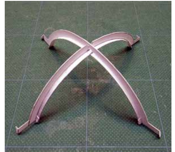
②③完成した交差アーチです。のりが乾くまで、少し時間をおきます。
